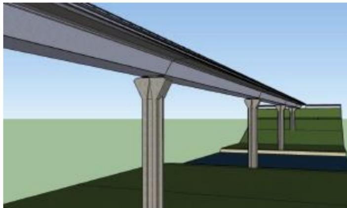
Illustration type du viaduc de la Vienne pour exemple d'une solution ossature mixte caisson à hauteur constante
